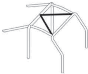
V2 V su tetto
